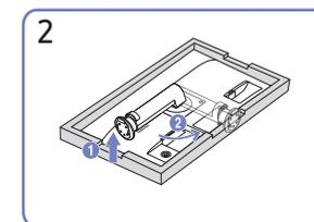
Poussez le col de socle assemblé dans le corps de l'appareil, dans le sens de la flèche, comme le montre l'illustration. Tournez complètement la vis de connexion dans le bas du socle, de façon à ce qu'il soit solidement fixé.
