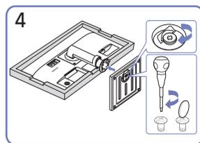
Insérez le support de base sur le socle dans la direction de la flèche. Fixez fermement la vis (à l'aide d'un tournevis ou d'une pièce de monnaie) au bas de la base-support.
