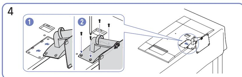
Poussez le pied monté dans le corps de l'appareil, dans le sens de la flèche, comme le montre l'illustration. Tournez complètement la vis de connexion dans le bas du corps de l'appareil, de façon à ce qu'il soit solidement fixé.
