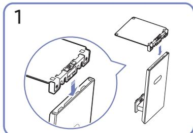
Mettez le pied dans le connecteur du pied, dans le sens indiqué sur l'illustration. Vérifiez que le connecteur du pied est correctement branché.
