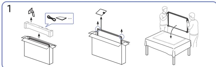
Comme indiqué sur la figure, retirez le produit et le coussin en mousse, puis placez le produit sur la table, sa face avant orientée vers le sol.
