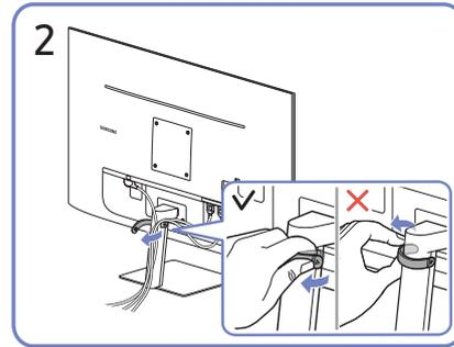
Tirez sur le côté droit du SUPPORT DE SOCLE DE CÂBLE pour le retirer du support. Le côté droit du câble peut être endommagé lorsqu'on le tire violemment.
