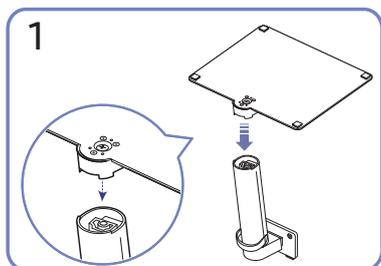
1 Mettez le pied dans le connecteur du pied, dans le sens indiqué sur l'illustration. Vérifiez que le connecteur du pied est correctement branché.
