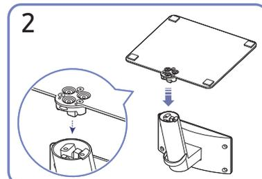
Mettez le pied dans le connecteur du pied, dans le sens indiqué sur l'illustration. Vérifiez que le connecteur du pied est correctement branché.
