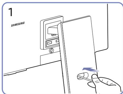
Faites passer les câbles à travers le trou dans le socle.
