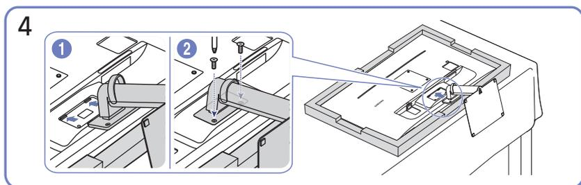
4 Poussez le pied monté dans le corps de l'appareil, dans le sens de la flèche, comme le montre l'illustration. Tournez complètement la vis de connexion dans le bas du corps de l'appareil, de façon à ce qu'il soit solidement fixé.
