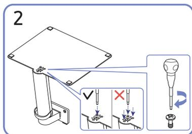
2 Tournez complètement la vis de connexion dans le bas du pied, de façon à ce qu'il soit solidement fixé. Attachez la grande vis au milieu pour l'assemblage.
