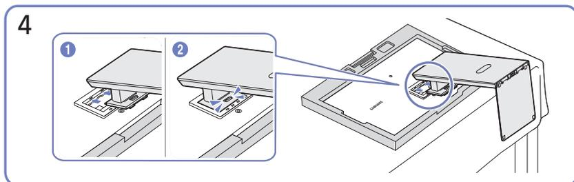
Poussez le pied monté dans le corps de l'appareil, dans le sens de la flèche, comme le montre l'illustration.
