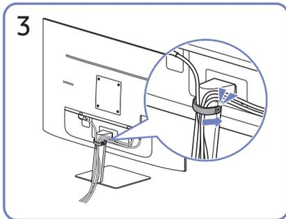
Placez les deux câbles dans le porte-câbles du support (SUPPORT DE SOCLE DE CÂBLE) pour organiser les câbles, comme indiqué sur la figure. Le montage est terminé.
